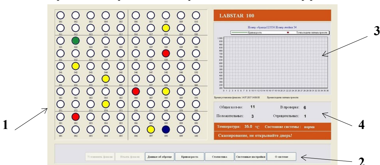
Рис. 12 - Главный компьютерный интерфейс LABSTAR 100 1-положение флаконов, 2-панель управления, 3-кривая роста, 4-информация о системе
