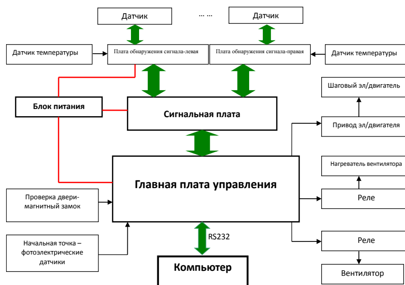
Рис. 9 - Принципиальная схема работы анализатора LABSTAR 100
